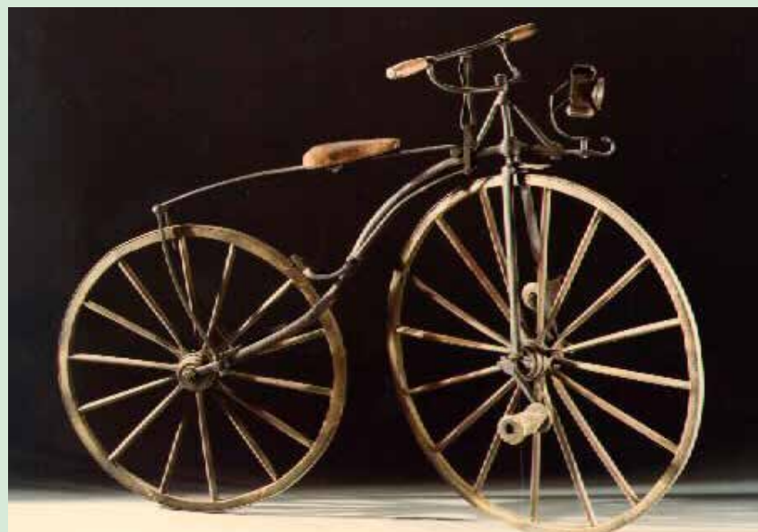
Bicicletta Michaudina: costruita nel 1855 da Ernesto Michaux (Francia). Innovazione: applicazione di leve con pedali alla ruota anteriore.
